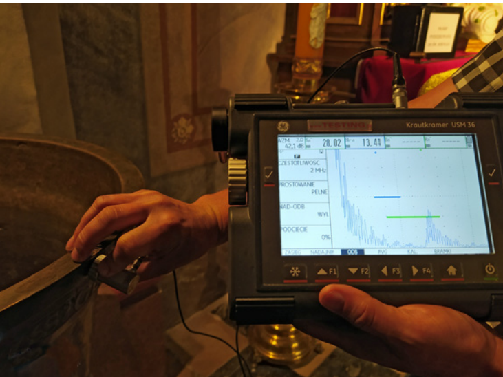
fot. z lewej: Badania nieniszczące chryzostomu w kościele św. Mikołaja w Krakowie, we współpracy z Wydziałem Konserwacji i Restauracji Dzieł Sztuki ASP w Krakowie i BTH TESTING
