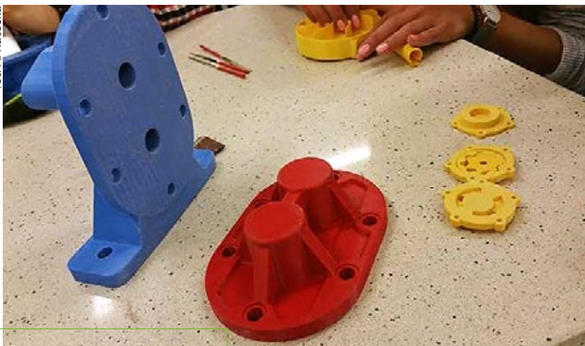
Modele pomp wytworzone metodą druku 3D
