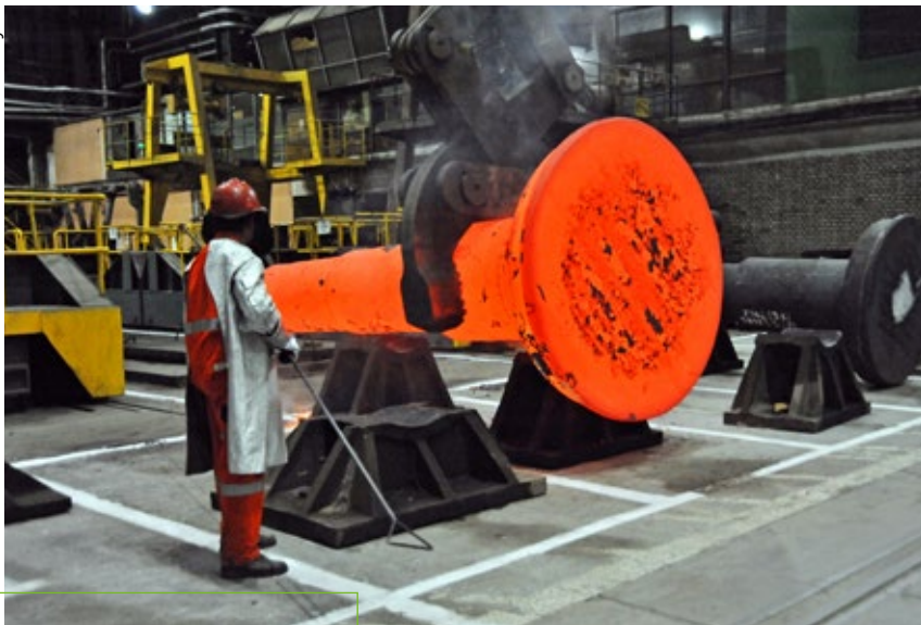
Hartowanie wałów głównych elektrowni wiatrowych wielkiej mocy
