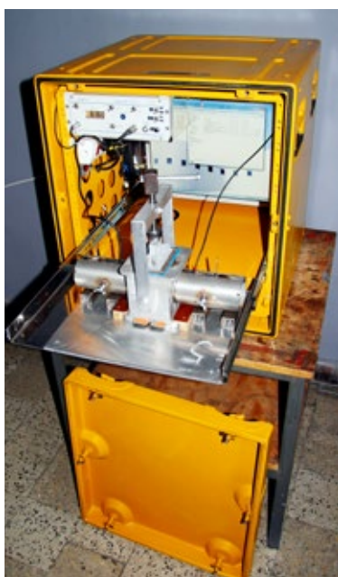
Rys. 5. Unikatowe stanowiska do badań ultradźwiękowych wiązania mas: a/ wersja laboratoryjna; b/ mobilne stanowisko przemysłowe
