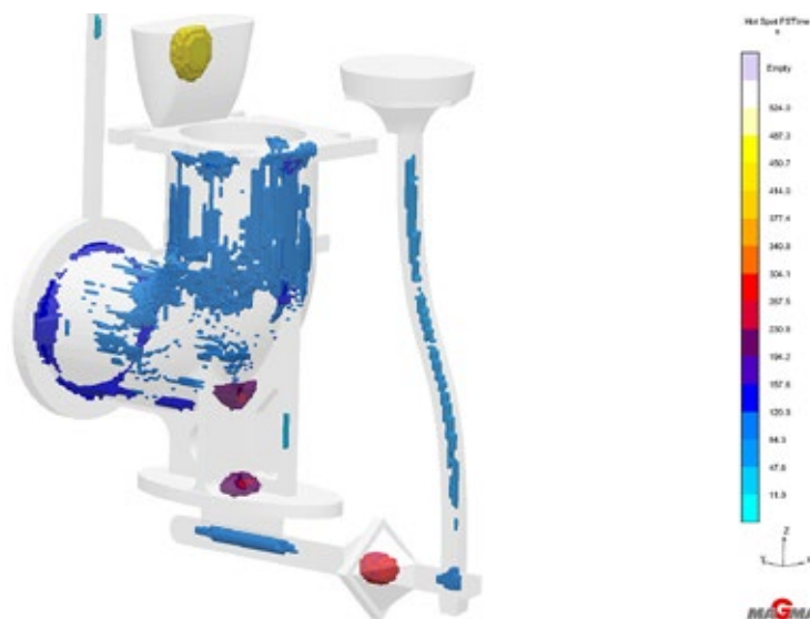
Rys. 1. Rozkład węzłów cieplnych w odlewie uzyskanych w wyniku symulacji przeprowadzonej w programie MAGMA 5.3
