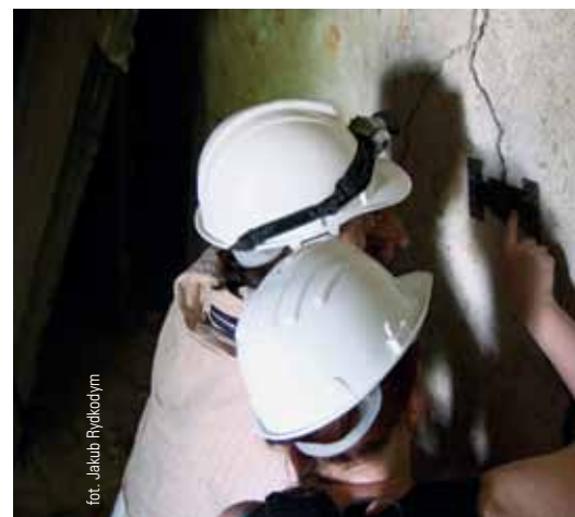
Monitoring zarysowania konstrukcji murewej Zespołu Pałacowego w Gorzanowie 2014 r.
