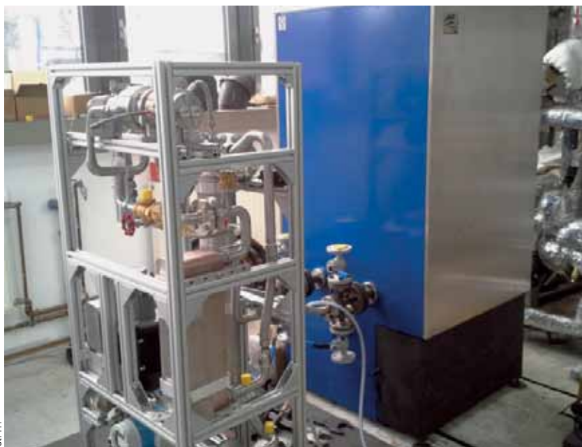
Domowa instalacja 20 kW z wykorzystaniem układu ORC (IMP PAN Gdańsk)
