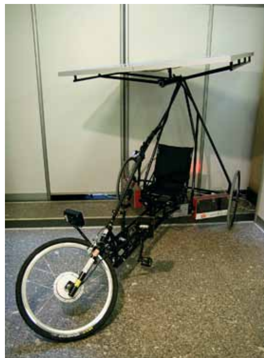
Rower fotowoltaiczny wykonany przez studentów koła naukowego Grzała.
