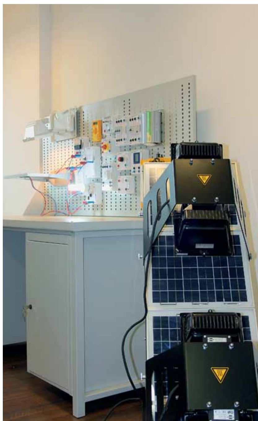
Zestaw dydaktyczny do budowania instalacji fotowoltaicznych typu On-grid i Off-grid w Miękini.
