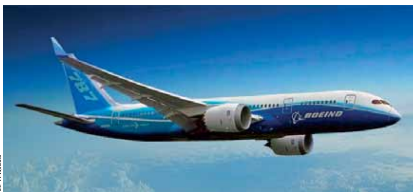
Fig. 7. Bombowce B-2 Spirit oraz F-117 Nighthawk zbudowane w technologii stealth z wykorzystaniem nanokompozytów. Bardziej pokojowy Boeing 787 Dreamliner także powstał w większości z materiałów kompozytowych.
