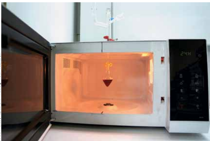
Rys. 12. Moment przed „spustem surówki” – świeża porcja nanocząstek metalicznych czeka na dalszą obróbkę
