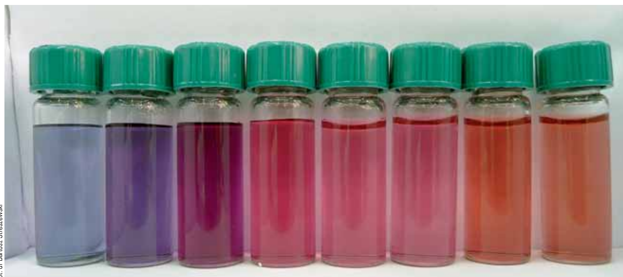
Rys. 9. Koloidy zawierające nanocząstki Au o różnych rozmiarach
