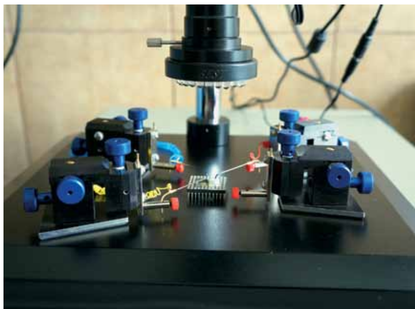
Rys. 13. „Patrzcie, chyba nasz nowy tranzystor działa...” – pierwsze testy elementów elektronicznych powstałych z udziałem nanocząstek i polimerów
