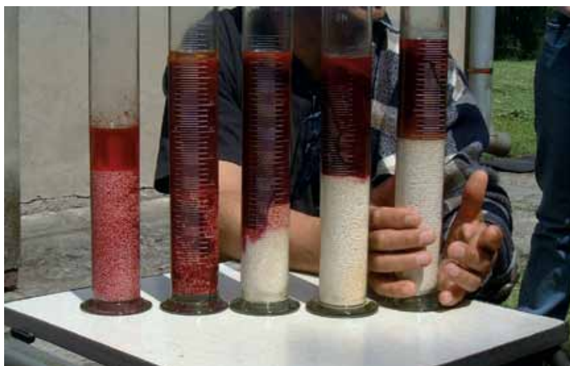
Prezentacja wodoodporności mieszaniny saletru z guar gum w różnej proporcji w Centralnym Laboratorium Techniki Strzelniczej i Materiałów Wybuchowych
