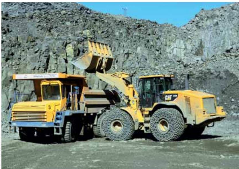
Załadunek urobku na ładowarkę kotową
