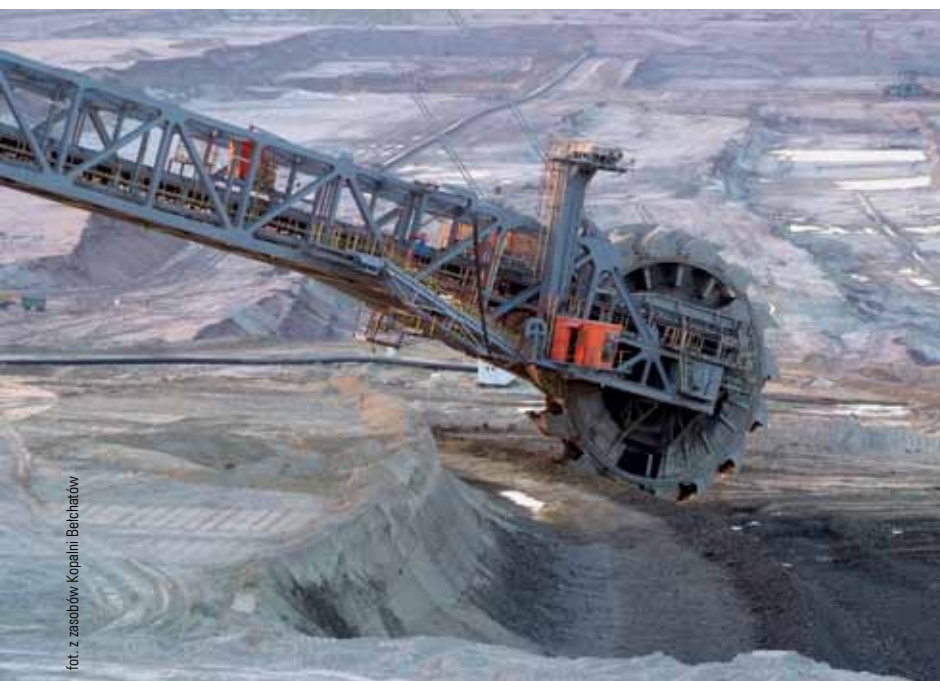
Wysięgnik z kołem urabiającym koparki wieloczerpakowej w Kopalni Bełchatów
