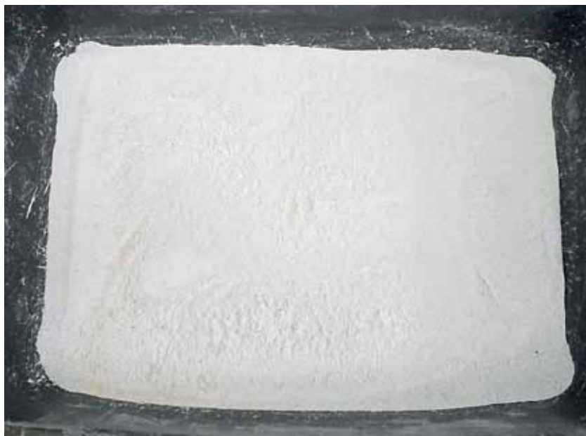
Analog gruntu księżycowego AGK
