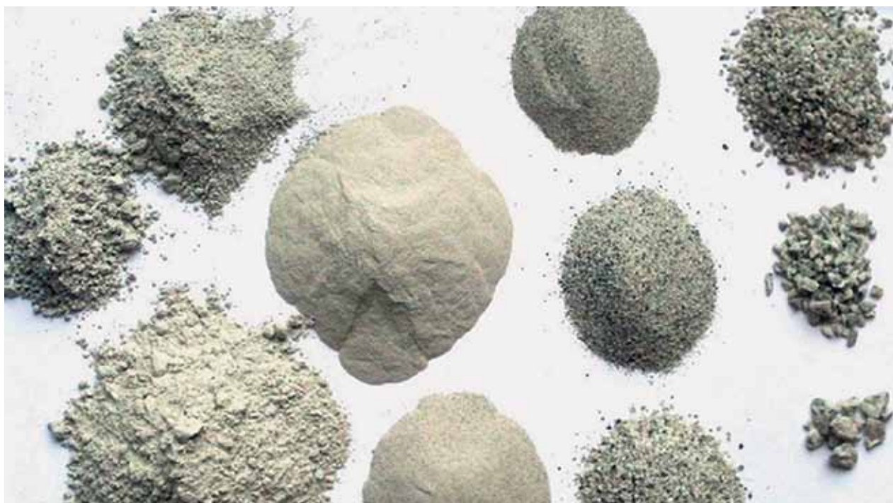
Fracje ziarnowe analogu gruntu księżycowego
