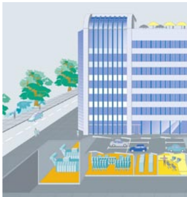
Rys. 14. Podziemna stacja wewnętrzna gazowa zlokalizowana w centrum miasta
